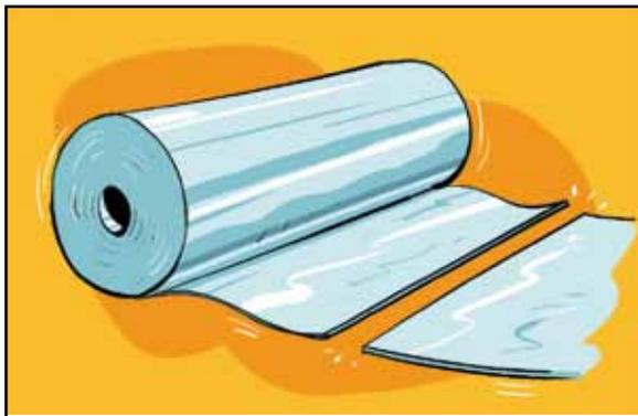
**1** Las láminas de acero o aluminio ya revestidos llegan a la planta metalgráfica en bobinas de gran tamaño y, a veces, en hojas.
