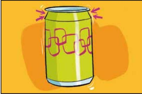
**13** Las latas pasan a continuación a una máquina que reduce el diámetro de la pared en la parte alta del envase. Esta operación se denomina “necked-in”. El borde superior del bote es moldeado hacia fuera para poder recibir el cierre una vez acabado el proceso de llenado.
