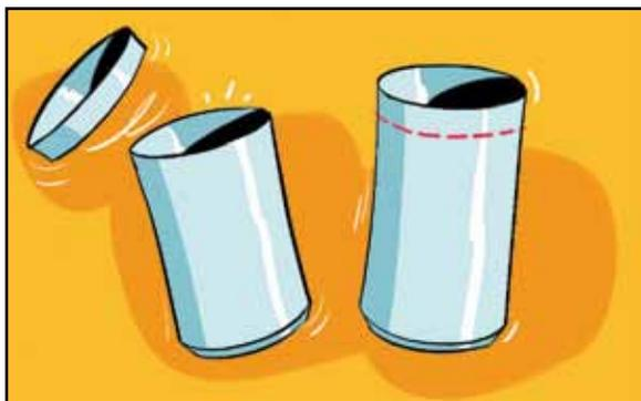
4 La parte irregular superior se corta, ajustando cada pieza a la altura precisa. (El material sobrante se recicla).
