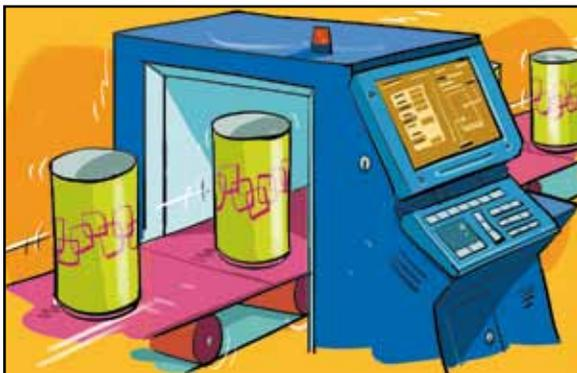
**12** Las latas pasan de nuevo por un horno para el secado del revestimiento interno.
