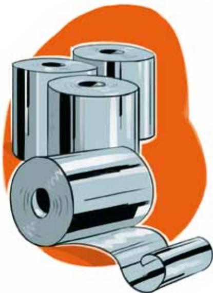
La hojalata puede definirse de una manera elemental como una hoja de acero de entre 0,14 y 0,49 mm de espesor, revestida por ambas caras con una película de estaño.
